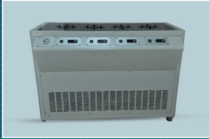
SDM Torino 500/S Akma/Donma Noktası Ölçüm Cihazı
