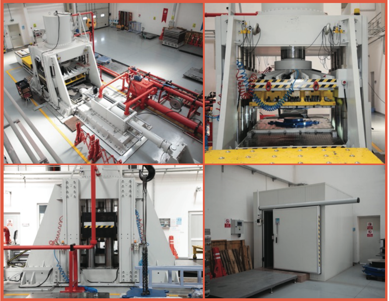
Şekil 1. ESQUAKE deprem izolatör test düzeneği
